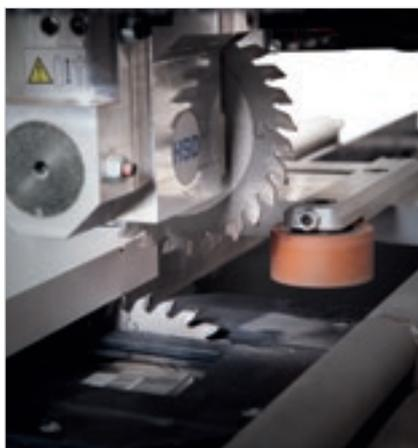
Insider M способен исполнять любые операции горизонтального и вертикального (верхнего и нижнего) сверления, пазования и обработок при помощи электрошпинделя.
