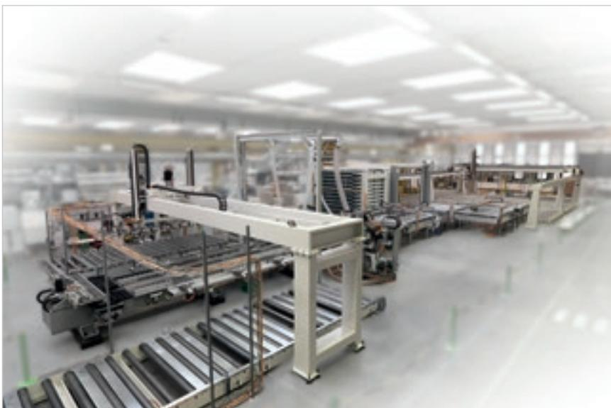
Система Batch-One с межоперационными магазинами (Буфер и Сортировщик), полностью встроенными в станок.
