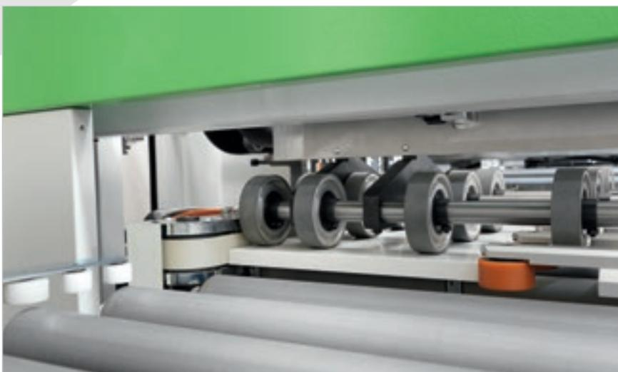
**Система ввода панелей в сочетании с верхним прижимом обеспечивает надёжное удержание панели также и при сверлении снизу. Кроме того, оно позволяет, совместно со срабатыванием фотоэлемента на входе и с боковым выравнивателем, производить автоматическое считывание размеров заготовки.**
